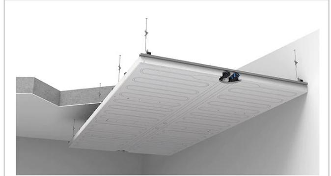
il riscaldamento a soffitto è una soluzione economica in quanto non **necessita di opere murarie** e non si deve demolire una sezione dell'abitazione per installare i pannelli radianti nel soffitto. Non è adatto per locali alti (oltre 3-3.5m).
